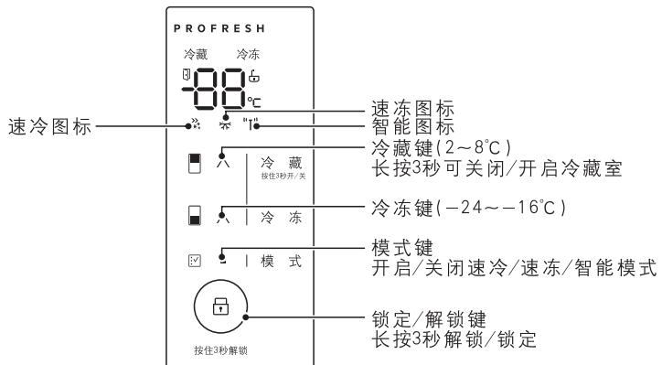
当冷藏门或冷冻门打开时响开门音乐铃声；若开门时间持续120秒，则蜂鸣器报警，直至冷藏门或冷冻门关。
