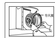
6 按风轮帽上的箭头指示方向旋下风轮帽，取出风轮。
