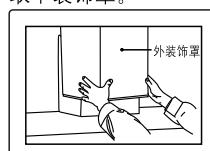
4 拧下机箱盖板的螺钉并取下机箱盖板。
