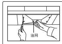
3 拧下固定下装饰罩的螺钉（在机体后部），取下装饰罩。
