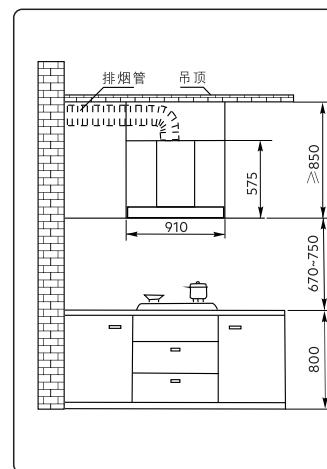
出风管走吊顶安装示意图
