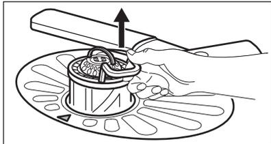
2. 拆下过滤器 (C) 中的过滤器 (B)。
