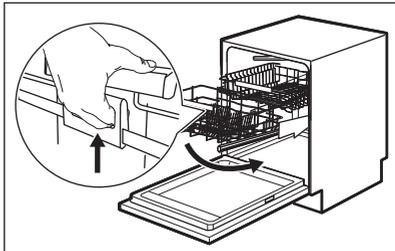
洗涤篮松开之后, 向下按压机架。装置重新回到较低一级的默认位置上。有两种方法可降低洗涤篮, 具体取决于装载量:
