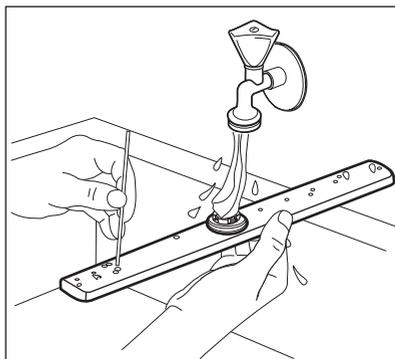
4. 要将喷淋臂重新装回，请向上按压喷淋臂，同时将它逆时针旋转，直到它锁定位。
