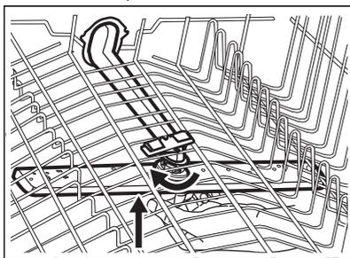
3. 在流动的水下清洗喷淋臂。使用一个又细又尖的工具，例如牙签，以剔出洞眼里的灰尘颗粒。
