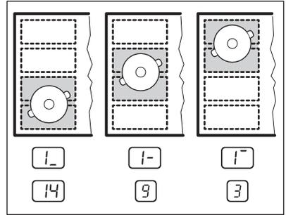
可以分别为每个位置更改加热设置。下次启用此功能时，炉灶将会显示所设置的加热设置。
