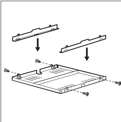
如果使用安全盖（可选配件），则炉灶前方不需要保留 **2 mm** 的通风空间，炉灶正下方也不需要铺设保护地板。在某些国家/地区，无法获得保护箱配件。请联系当地供应商。
